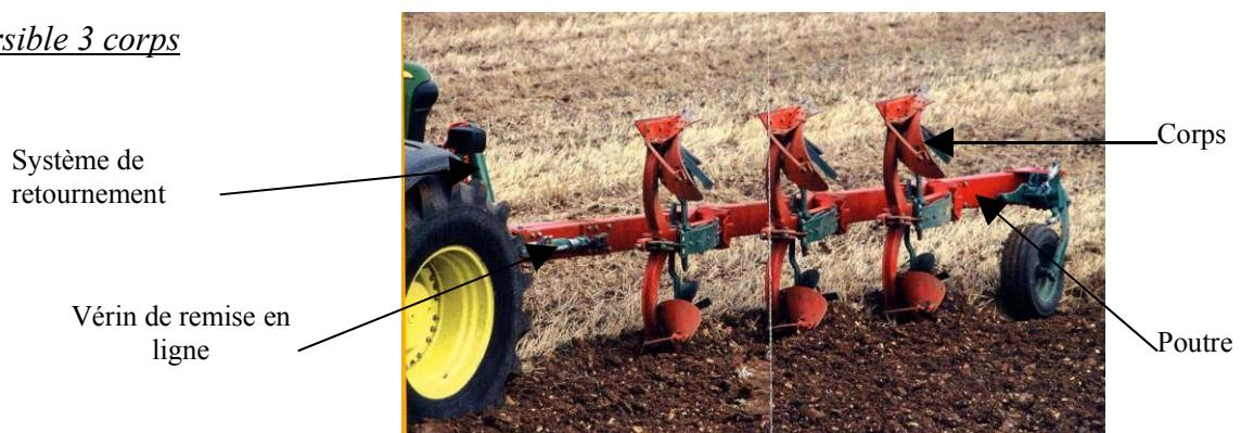
Les charrues « nouvelle génération » permettent de travailler avec la roue du tracteur dans ou hors du sillon. Un parallélogramme est situé entre le système de retournement et la poutre
